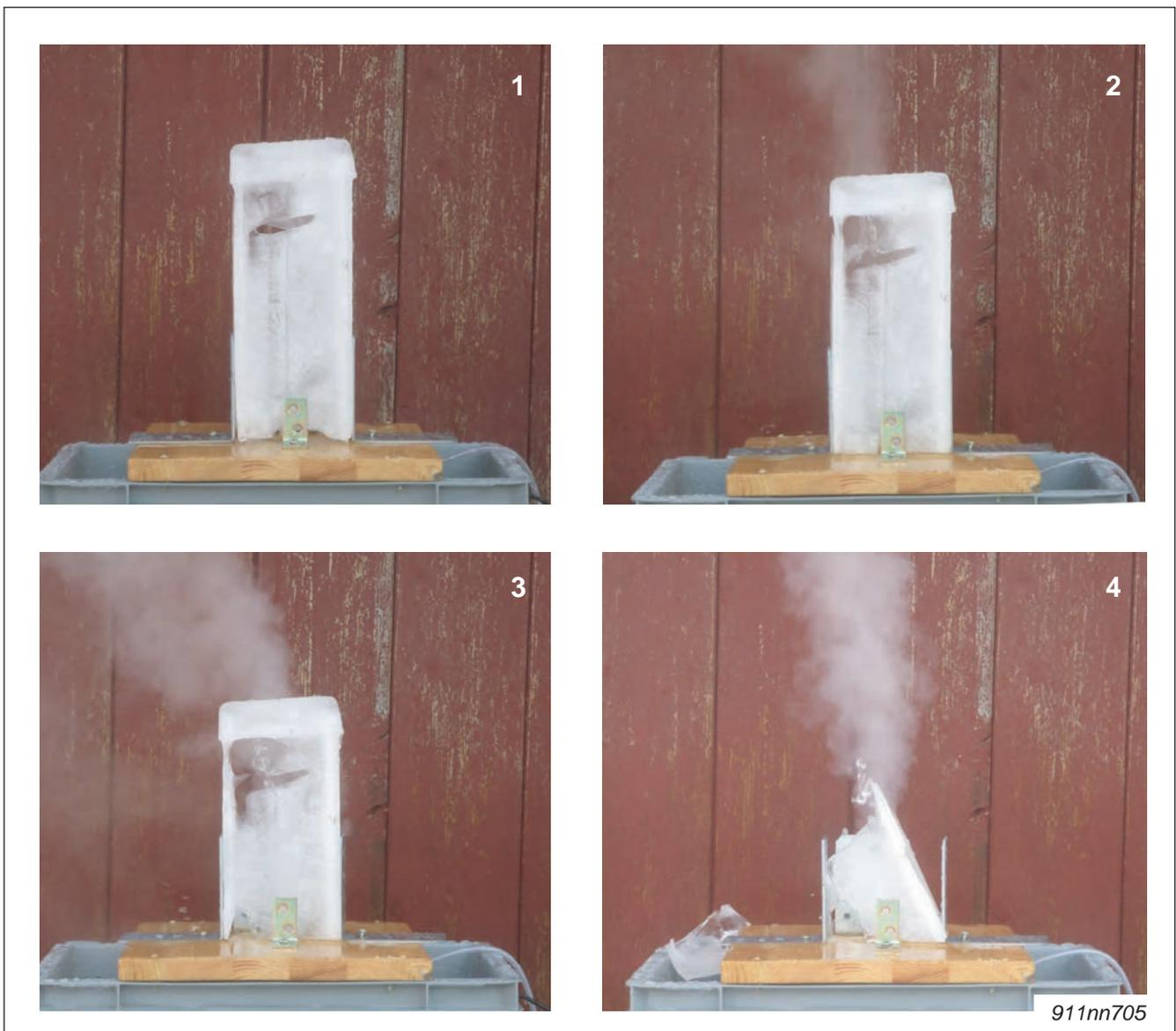
Fig. 35-4 Versuchsdurchführung: Aufschmelzen / Zerstören des Eisblocks
